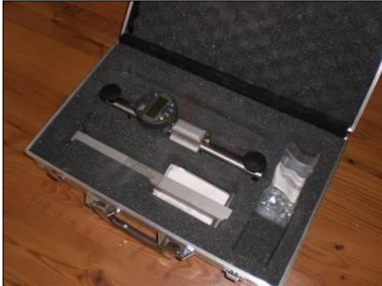
*Deformometro e barra di taratura.*
