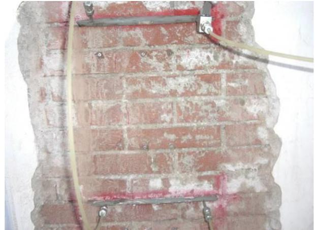
*Dettaglio della pompa idraulica e dettaglio dei martinetti installati.*
