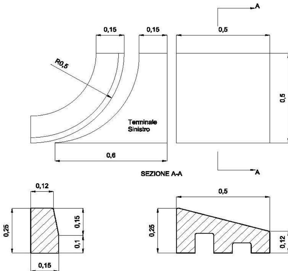
**Le marmette realizzate con superficie in cia liscio a vista a getto fluido con cemento portland 425 e quarzo aferoidile, additivato contro la antigelatività e additivato con pigmento giallo.**
