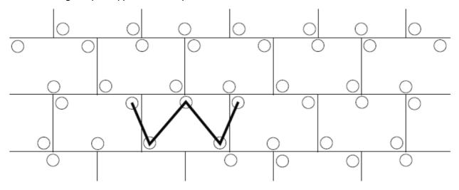
Nello schema a W ogni pannello è fissato con 3 tasselli: questo schema è possibile per l'isolamento termico con pannelli in MW
